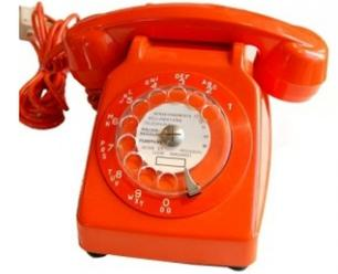
**Principaux matériaux :** Corps, combiné et cadran en plastique, fil électrique en cuivre recouvert de plastique.
