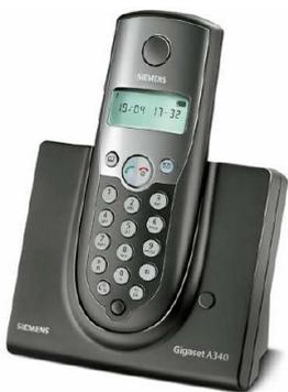
Les téléphones sans fil ont une portée limitée (100 à 300 m maximum), ce qui permet des déplacements dans une habitation ou une entreprise. Il est constitué d'une base, connectée au réseau téléphonique, contenant un émetteur/récepteur radio et un haut-parleur pour la sonnerie, et d'un combiné muni d'un microphone et d'un écouteur permettant la conversation.
